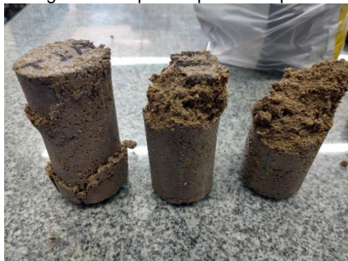
Figura 4. Corpos de prova rompidos.
