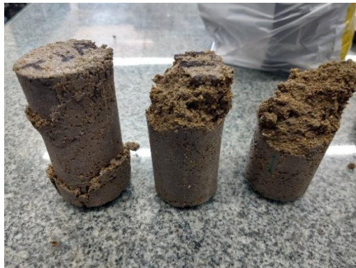
Figura 4. Corpos de prova rompidos. Fonte: Autores (2019).
