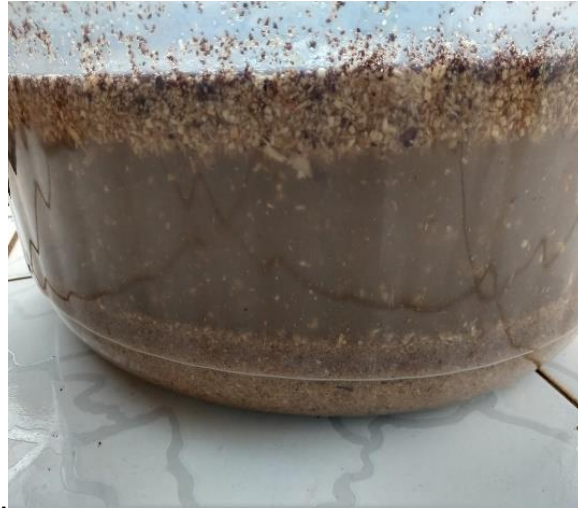
Figura 2. Serragem no processo de lavagem, e com os resíduos maiores emergindo Fonte: Fonte: Autores (2019).
